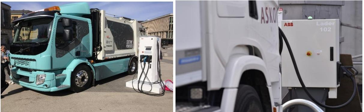
Figura 53. Estação de carregamento elétrico para veículos pesados
